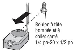
**1.4C** Insérer le boulon dans le trou du support de capteur et le fixer avec l'écrou à oreilles. Les lentilles des deux capteurs doivent pointer l'une vers l'autre. S'assurer que la lentille n'est pas obstruée par le support de capteur.
