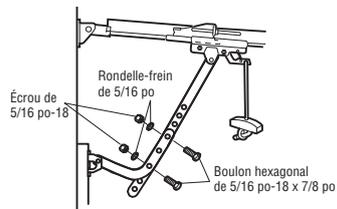
**REMARQUE :** Si les trous ne s'alignent pas, inverser la biellette droite. Sélectionnez deux trous alignés (aussi loin que possible) et fixez-les avec les boulons, les écrous et les rondelles.
