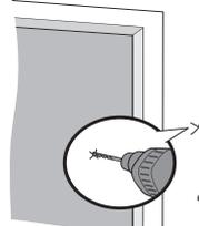
**1.8** Placer le trou inférieur de la commande de porte sur la vis et faites glisser en place. Fixer la vis du haut.
