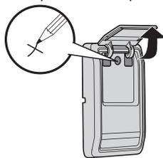
**1.7** Retirer la commande de la porte du mur et percer un trou de 4 mm (5/32 po) pour la vis du haut.
