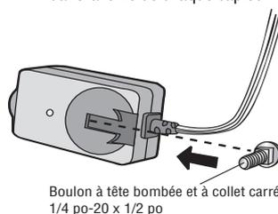
**1.3A** Insérer le boulon dans le trou du support de capteur et le fixer avec l'écrou à oreilles. Les lentilles des deux capteurs doivent pointer l'une vers l'autre. S'assurer que la lentille n'est pas obstruée par le support de capteur.
