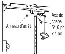
**9.3** Fixez la biellette courbée sur le support de porte à l'aide d'un axe de chape. Fixez-la avec un anneau d'arrêt.
