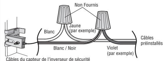
**2.4B** Au niveau de l'ouvre-porte de garage, enlever 11 mm (7/16 po) d'isolation de chaque extrémité des fils choisis précédemment pour les capteurs d'inversion de sécurité. Torsader les fils de même couleur.
