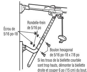
**9.5** Tirez la poignée de déverrouillage de secours vers l'ouvre-porte de garage de façon à ce que la biellette de dégagement du chariot soit horizontale. Le chariot se réenclenchera automatiquement lorsque l'ouvre-porte de garage fonctionnera.
