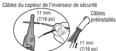
**2.3B** Connecter les fils préinstallés aux fils des capteurs avec un capuchon de connexion en s'assurant que les couleurs correspondent sur chaque capteur. Par exemple, le fil blanc se raccorde au fil jaune et le fil blanc/noir se raccorde au fil violet.
