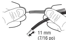
**2.3A** Insérer les fils blanc dans la borne blanche de l'ouvre-porte de garage. Insérer les fils blanc-noir dans la borne grise de l'ouvre-porte de garage. Pour insérer ou retirer les fils de la borne, appuyer sur la languette avec la pointe du tournevis.
