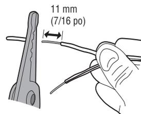
**2.3** Relier le fil aux bornes rouge et blanche de l'ouvre-porte de garage. Pour insérer les fils ou les libérer de la borne, appuyer sur la languette avec la pointe du tournevis.
