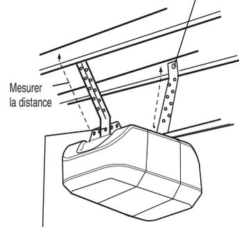
Boulon de 5/16 po-18 x 7/8 po, Rondelle frein de 5/16 po, Écrou de 5/16 po-18
