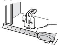
**1.2C** Fixer les supports de capteurs au sol avec des ancrages de béton (non fournis).
