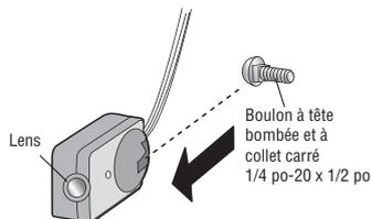
**1.4B** Insérer le boulon dans le trou du support de capteur et le fixer avec l'écrou à oreilles. Les lentilles des deux capteurs doivent pointer l'une vers l'autre. S'assurer que la lentille n'est pas obstruée par le support de capteur.
