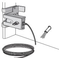
**2.2B** Séparer les câbles du capteur d'inversion de sécurité et enlever 11 mm (7/16 po) d'isolant de chaque extrémité. Choisir deux des câbles préinstallés et enlever 11 mm (7/16 po) d'isolant de chaque extrémité. S'assurer de choisir les fils préinstallés de même couleur pour chacun des capteurs.
