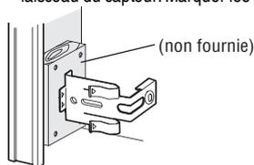
**1.2B** Percer des avant-trous de 3/16 po pour chaque support de capteur et fixer les supports sur le mur avec les tire-fond (non fournis).
