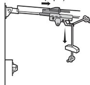
**9.2** Fixez la biellette droite sur le chariot extérieur à l'aide d'un axe de chape. Fixez-la avec un anneau d'arrêt.
