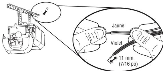
**2.5B** Insérer les fils reliés aux fils blancs des capteurs de sécurité à la borne blanche de l'ouvre-porte de garage. Insérer les fils reliés aux fils blancs/noirs des capteurs de sécurité à la borne grise de l'ouvre-porte de garage.
